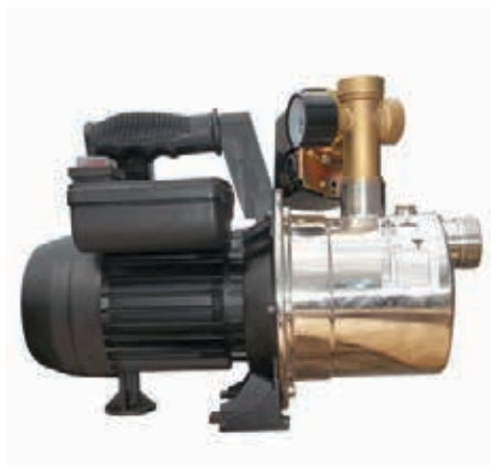
Pompa BJ 45/75 z osprzętem hydroforowym Pompa wraz z zamontowanym osprzętem hydroforowym: wyłącznikiem ciśnieniowym, manometrem, wyjściem tłocznym pięciodrożnym, kablem zasilającym z wtyczką.
