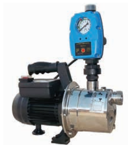
Pompa BJ 45/75 z automatem hydroforowym typu PC (PC15, PC16, PC10P, PC59) Zestaw działa całkowicie automatycznie przy odkreceniu wody uruchamia pompę. Przy zakreceniu wyłącza pompę. Urządzenie posiada zabezpieczenie przed suchobiegiem. W razie braku wody PC 59 wyłączy pompę nie dopuszczając do awarii.
